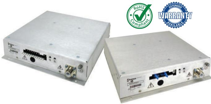
斯派曼 MXR 是一款精密调节的高性能直流-直流转换器。MXR 的低纹波规格使其成为质谱分析和电子显微镜应用的理想选择。MXR20 的额定电压为 20kV，额定电流为 300uA；MXR30 的额定电压为 30kV，电流为 300uA。两者都封装在一个屏蔽的金属外壳里，并可提供模拟或RS-232 数字控制选项。此电源通过一个逻辑信号输入来控制输出极性逆变。提供电压、极性和电流监测。数字版本还具有光隔离互锁输入（高压使能/抑制）。MXR 系列可以轻松定制，可提供电流控制、改善纹波性能和更高的电压和电流能力，以满足 OEM 需求。
