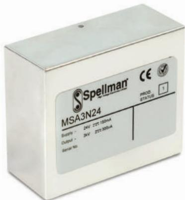
MSA 系列是紧凑的可安装在印刷电路板 (PCB) 上的高压电源模块, 从 1kV 至 3kV, 可选正的或负的输出极性。MSA 系列的特点是 0-10Vdc 可变电压编程等于 0-100% 额定输出电压。提供一个电压监测, 0-10Vdc 等于 0-100% 的额定输出电压。此外, 状态信号和使能信号提供对电源的简单控制。所有的电源都有内置的故障保护。
