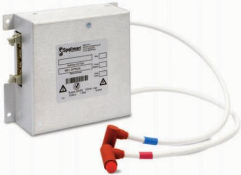
斯派曼的 MI1.5PN24 是一款良好调节的高性能 DC-DC 转换器, 具有浮地 1.5kV @ 6.5mA 输出, 它的工作范围为 300V-1500V。输出是隔离的; 这允许连接负载的 +Ve, -Ve 或可切换极性, 并且脉冲电流被包含在规定的路径内, 减少噪声和干扰信号。MI1.5PN24 低输出纹波规格使得它非常适合于质谱应用中的脉冲器使用。此模块封装在屏蔽金属外壳中并且高压输出时通过两个固定的电缆提供。MI1.5PN24 具有一个大的、高质量的电容和坚固的输出网络, 这允许高能脉冲负载连续供电而不需要电压骤降或损坏到单元电路。此单元有远程 0-10Vdc = 0-100% 额定电压编程和电压监测。一个 TTL 兼容的使能信号提供了简单的高压输出控制。
