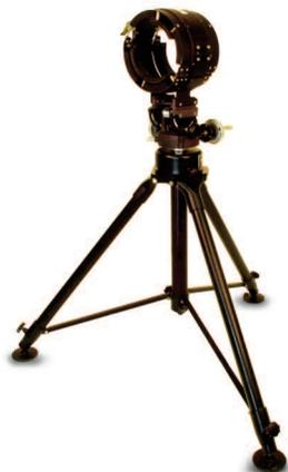
斯派曼 LPX 系列可以完美适用于目前苛刻的 NDT 检验需求。LPX 电源是坚固的、易于运输, 可选的 LPX1620 管头支架可以快速地安装并为最佳的图像质量提供刚性支撑。管头支架包含伸缩支腿、手轮驱动的可变高度调整并可锁定手轮控制管头倾斜度和水平旋转。为了安全的安装和减振, 管头托架是加衬垫的。包括一个气泡式指示器, 快速并简便地调平管头。
