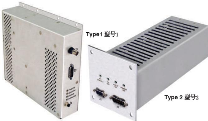
斯派曼 ESC 系列电子卡盘电源为静电卡盘芯片加工应用，提供所需的清洁、精确的电压。这些定制设计，好的调节在漫长的制程周期中提供精确的保护芯片。可提供对地参考可逆输出的型号，还可提供浮地双极输出并带有相关的浮地中间抽头点的型号。综合的故障诊断电路监测电源功能，并将状态数据传送到用户界面。ESC 系列电源采用紧凑、轻便封装，为 OEM 而设计，安装要求极小的系统空间。
