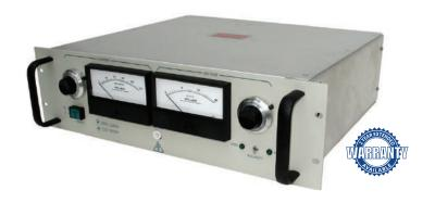
斯派曼 CZE1000R 是一个全功能的机架式安装的高压电源,实验室使用的理想之选。以满足需要一个"热切换"可逆的输出电压而设计。输出极性可以通过前面板开关快速并安全地反转。
