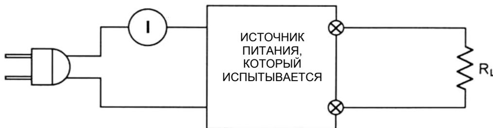
Рис. 11. Измерение входного переменного тока
