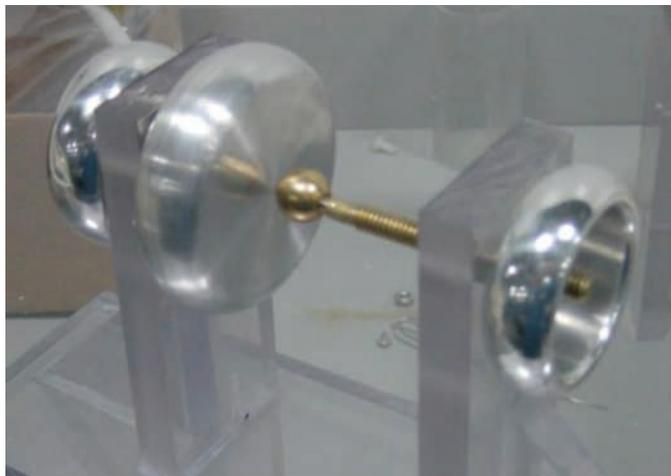
Рисунок 3. Искровой промежуток плоскость — сфера.
