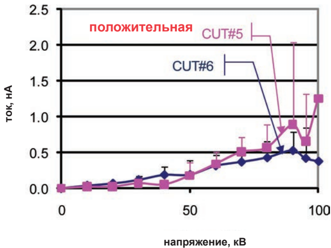
Рисунок 7. CUT#5, CUT#6. Ток утечки при положительной полярности.
