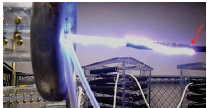
Рисунок 11. CUT#6. Фотография поверхностного перекрытия. Положительная полярность.
