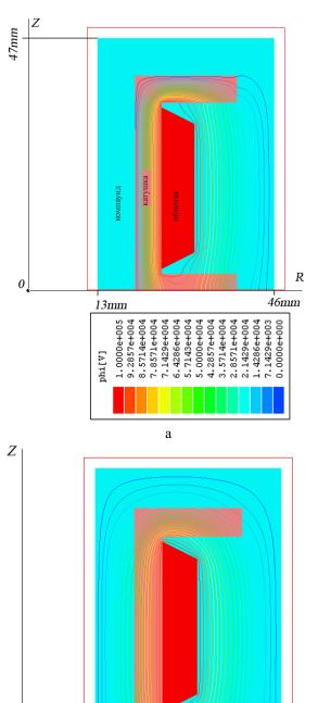
Рис. 4. Распределение электрического поля в герметизированной катушке. а — поле постоянного тока (задача проводимости); b — переменный ток (задача электростатики)
