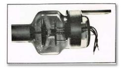
на стеклянные поверхности, что в будущем вызывает дуговой разряд и поломку трубки. Дуговой пробой выводит испаренный материал из состояния покоя и может вызвать протравливание на стеклянных изоляторах. Такое состояние часто называют растрескиванием или травлением.
