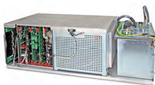
Корпус EDITOR HFe-UT для размещения под столом
