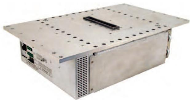
スペルマンのX線源Monoblock® XRB200PN400は、OEMアプリケーション向けに設計されており、内部のX線管に400ワットで最大200kVまでの電力を供給します。ユニバーサル入力、小型パッケージ、標準アナログ、RS-232デジタルインターフェースなどの機能により、XRBをお客様のX線装置に容易に組み込むことが可能です。標準モデルは、ファンビームのビーム形状です。独自のエミッション制御回路はX線管電流の調整に優れており、際立った安定性を提供します。
