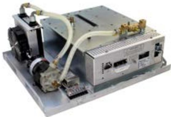
スペルマンのMonoblock® X線発生源のXRB160PN480/1はOEMアプリケーション向けに設計されており、内部のX線管に最大480W160kVまでの電力を供給します。力率改善、小型パッケージ・サイズ、さらに標準でアナログ・モニタリングおよびRS-232デジタル・インターフェース搭載という特徴から、XRB160PN480/1をお客様のX線分析装置に容易に組み込むことが可能です。標準品でファンビームをご利用いただけます。当社独自のエミッション制御回路はX線管電流の調整に優れており、しかも際立った安定性を提供します。
