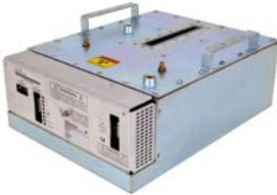
スペルマンのMonoblock®X線ジェネレーター、XRB160PN192はOEMアプリケーション向けに設計されており、内部のX線管に最大192W、160kVまでの電力を供給します。ユニバーサル入力、小型パッケージ・サイズ、さらに標準でアナログおよびRS-232デジタル・インターフェース搭載という特徴から、XRB160PN192をお客様のX線分析装置に容易に組み込むことが可能です。標準品でファンビームをご利用いただけます。独自のエミッション制御回路は、卓越した安定性能とともに、X線管電流の優れた調整を提供します。
