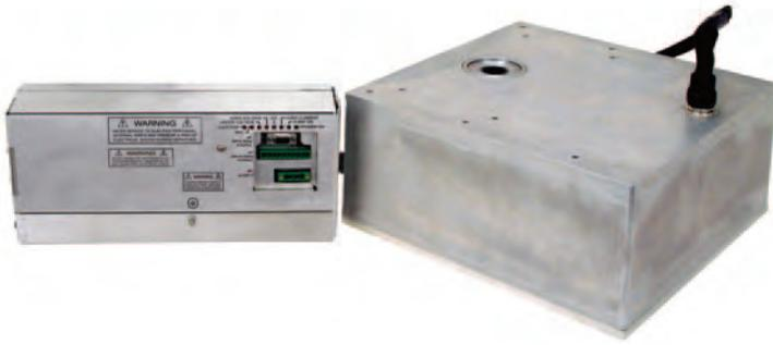
スペルマンのX線源Monoblock®XRB150PN600は、OEMアプリケーション向けに設計されており、内部のX線管に600Wで最大150kVまでの電力を供給します。力率補正、小型パッケージ、標準アナログ、RS-232デジタル・インターフェースなどの機能により、XRBをお客様のX線装置に容易に組み込むことが可能です。標準モデルは、コーンビームのビーム形状です。独自のエミッション制御回路はX線管電流の調整に優れており、際立った安定性を提供します。
