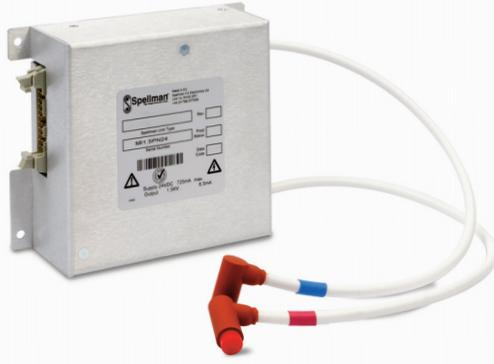
スペルマンのMI1.5PN24は、安定した高性能DC-DCコンバータで、1.5kV@6.5mAのフローティング出力、動作範囲300V~1500Vを特徴としています。出力は絶縁されており、これにより+Ve、-Veまたは極性切換え可能な負荷に接続でき、パルス電流を所定の経路に収め、ノイズや干渉信号を減少させることができます。MI1.5PN24の低出力リップル仕様は、質量分析アプリケーションのパルス器での使用に最適です。このモジュールはシールドされた金属製の筐体に収められ、高圧出力は2本のキャプティブケーブルを介して提供されます。MI1.5PN24は、大型で高品質のキャパシタンスと堅牢な出力ネットワークを備えているため、高エネルギーパルス負荷に対して、大幅な電圧低下やユニット回路の損傷なしに連続的に電力を供給することが可能です。リモートで0-10Vdc=0-100%定格電圧のプログラミングと電圧モニターが可能です。TTL準拠のイネーブル信号により、高圧出力の簡易制御が可能です。
