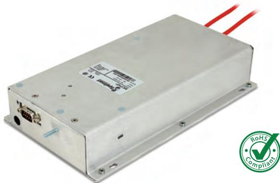
スペルマンのMCP4は、600 $\mu$ A出力で4kVフローティング、15kVまでの絶縁耐圧を備えた、安定化された高性能DC-DCコンバーターです。MCP4の低出力リップル仕様と高い安定性により、電子増倍管(EM)、マイクロチャンネルプレート検出器(MCP)、チャンネル電子増倍管などの質量分析アプリケーションの検出器での使用に最適です。このモジュールは、シールドされた金属製の筐体にパッケージされており、高電圧出力は、2本の束ねられた1メートルのシールド付き同軸ケーブルを介して提供されます。ユニットには、リモート0-10Vdc = 0-100%定格電圧プログラミングおよび電圧モニターがあります。TTL準拠のイネーブル信号により、高電圧出力を簡単に制御できます。このユニットは、フローティングされている高電圧源とのクロストークを最小限に抑えるように特別に設計されています。MCP4は、OEM要件を満たすようカスタマイズも可能です。
