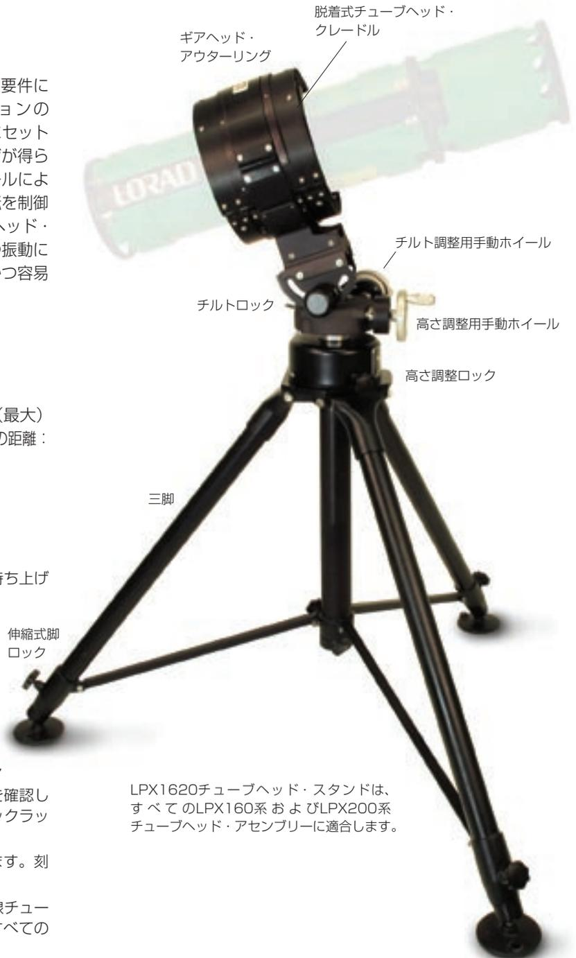
LPX1620チューブヘッド・スタンドは、すべてのLPX160系およびLPX200系チューブヘッド・アセンブリーに適合します。
