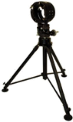
スペルマンのLPXシリーズは、現在要求されるNDT検査要件に最適です。LPXユニットは頑丈で運びやすく、オプションのLPX1620型チューブヘッド・スタンドを使用すれば簡単にセットアップでき、抜群の安全性によるブレのない鮮明なイメージが得られます。チューブヘッド・スタンドは伸縮式脚、手動ホイールによる高さ調整部、そしてチューブヘッドのチルトおよび横回転を制御するロック可能な手動ホイールを備えています。チューブヘッド・クレードルはクッション付きですので、しっかり固定しつつ振動による影響を軽減します。チューブヘッドの水平位置を迅速かつ容易に調整できるよう、気泡式水平器も備えています。
