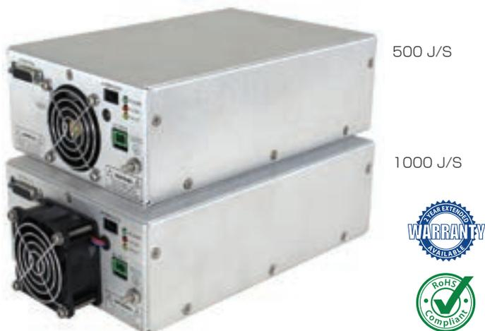
CCM1KWコンデンサ充電モジュールは、4000Vまでの出力電圧のもとで1秒あたり最大1000ジュールを供給すべく設計されました。力率改善AC入力、小パッケージ・サイズ、広範囲のアナログ・インターフェースにて、本製品はお客様のOEM装置設計への統合が簡単です。正負極いずれにも対応可能な本CCM1KW製品は完全にアーク、オープン、短絡モードから保護されています。より高い電力を必要とするアプリケーションでは、機器を並列に並べて操作できます。(詳しくはマニュアルをご覧ください。)
