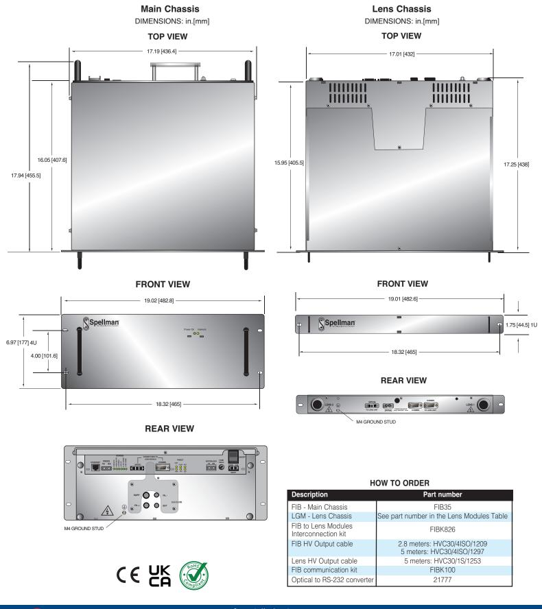
POWER SUPPLY FOR FOCUSED ION BEAM
