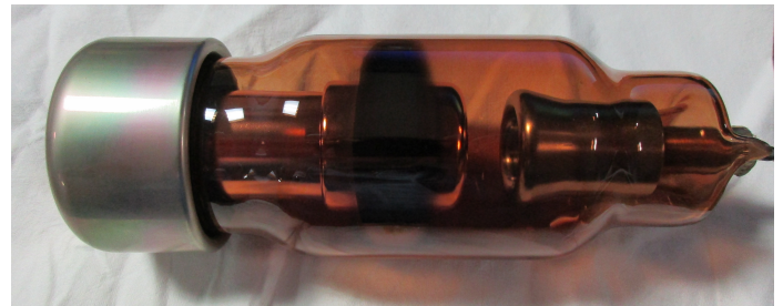
Рис. 9. Рентгеновская трубка, работающая в среде горячего масла с тонким слоем обуглившегося масла на поверхности
